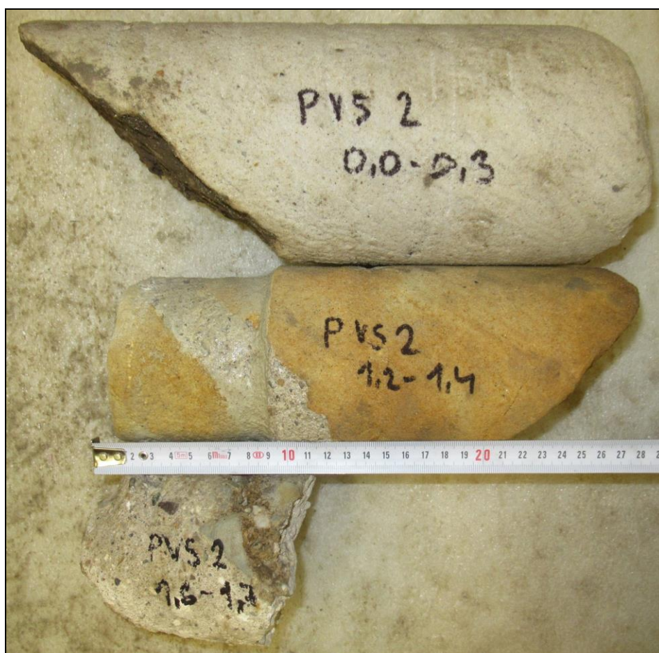
Foto 3: Části vývrtu PVS2 z různých hloubek
